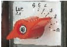
– Durch die Veränderung der Voreinstellung wird die Luftgeschwindigkeit im Bereich der Stauscheibe verändert, dadurch ist eine Beeinflussung der Flammenform möglich.
